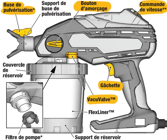
\* Les buses de pulvérisation bleues sont destinées à la pulvérisation de peinture et doivent être utilisées avec le filtre de pompe bleu. Les buses de pulvérisation vertes sont destinées à la pulvérisation de teinture et doivent être utilisées avec le filtre de pompe vert. (Le vert n'est pas inclus avec tous les modèles)
